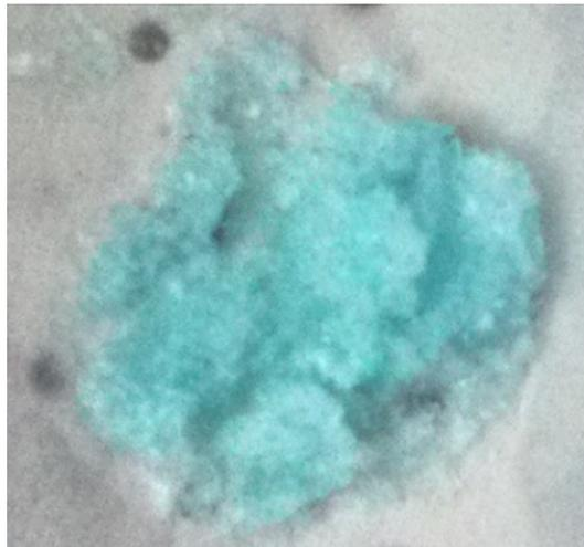
**Gambar 5.** Kristal Biru Kehijauan Ferro Sulfat dari Scrap Besi
